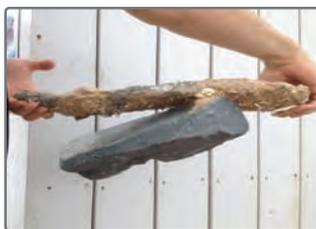
Sous l'effet de ce courant, les sels minéraux naturellement dissous dans l'eau de mer (principalement calcium et magnésium) forment des composés qui précipitent autour de l'armature et agissent comme un ciment naturel. Le Geocorail® se forme progressivement par accréation du sable, des graviers et des débris coquilliers environnants. A ce jour, les cinétiques ont permis d'obtenir des épaisseurs de 10 cm en un an.
